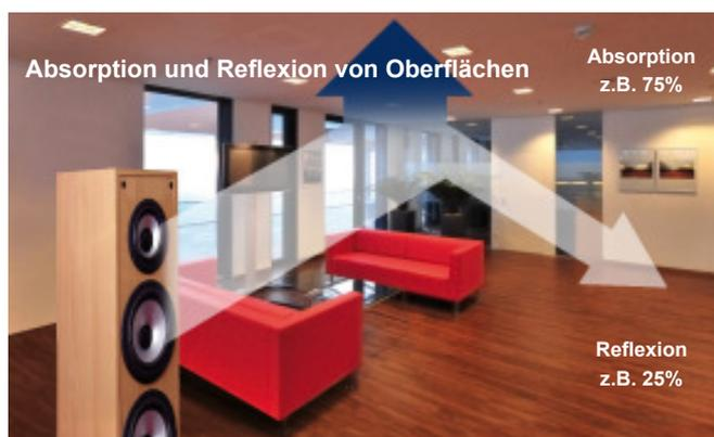
Trifft eine Schallwelle auf eine Oberfläche so wird ein Teil der Energie reflektiert, der andere Teil absorbiert (in Wärme umgewandelt). Dieser Verlust an Energie wird als Schallabsorption bezeichnet.
